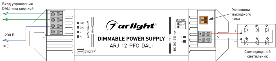
Рис.1. Подключение диммируемого блока питания
